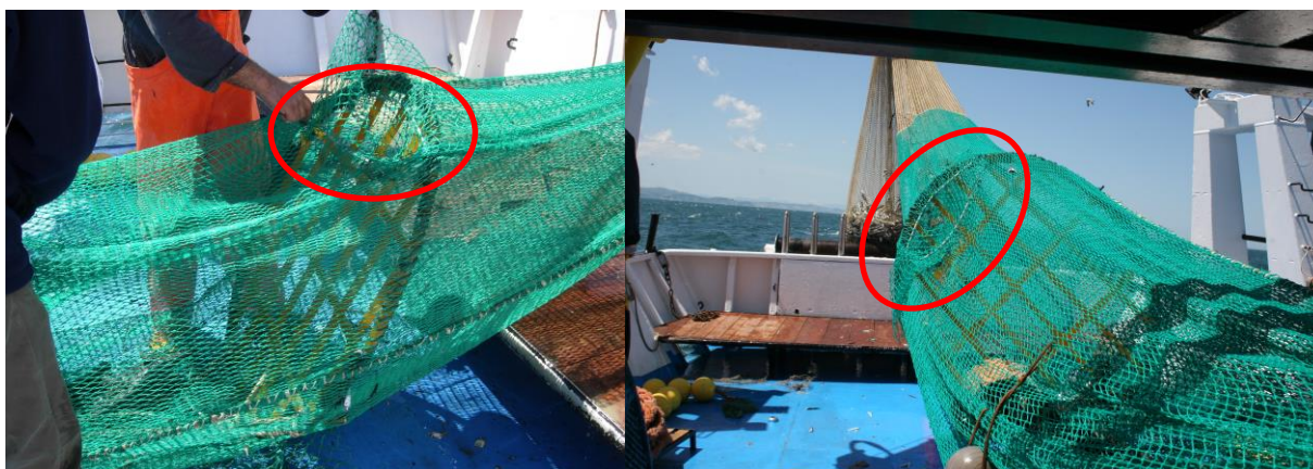
Figura 6. TED utilizzato durante la seconda campagna in mare di messa a punto; nel dettaglio è evidenziata l'apertura di fuga.
