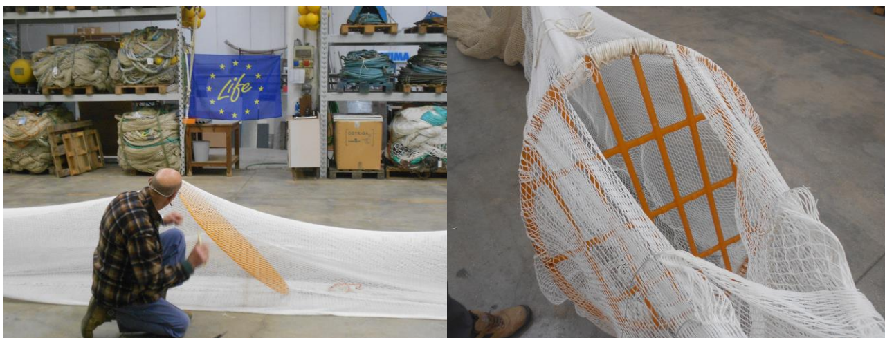
Figura 4. Montaggio della griglia all'interno dell'avansacco (prima campagna di messa a punto).
