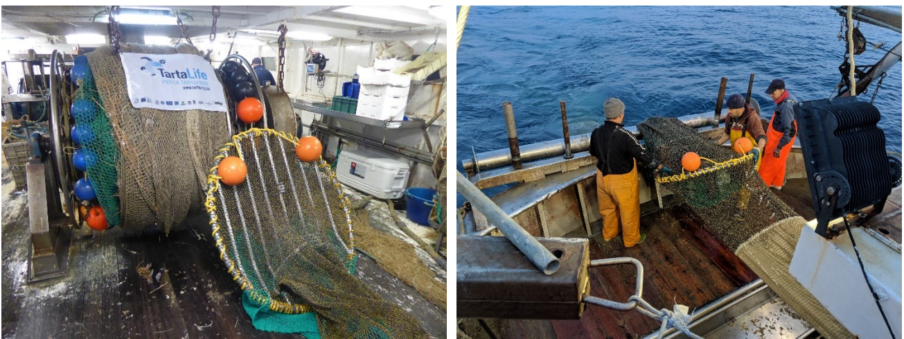
Figura 9. TED Supershooter impiegato per le prove in mare realizzate dal CNR a bordo del motopesca Airone Bianco II di Ancona; escape opening verso il basso.
