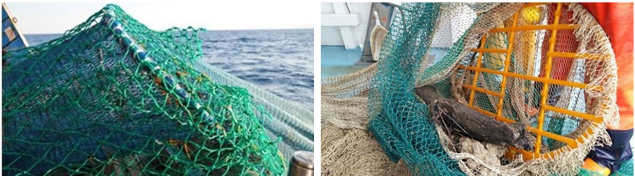
Figura 8. FLEXGRID a due fori laterali utilizzato per lo strascico a largo a bordo del motopesca Morlè di Livorno; escape opening verso l'alto.
