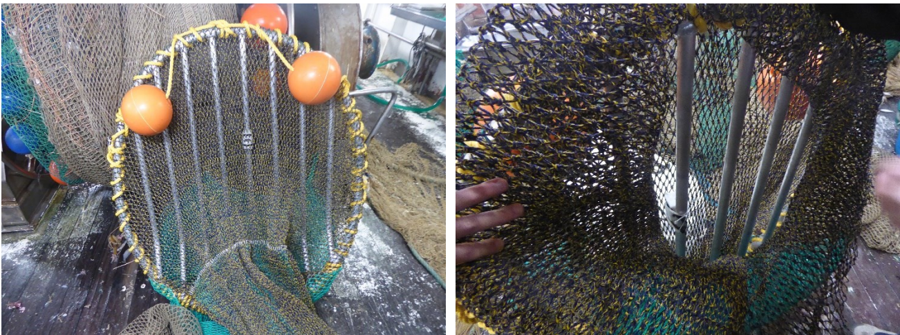
Figura 11. Sensore STAR-ODDI per il rilevamento dell'angolo di inclinazione della griglia montato sul Supershooter.
