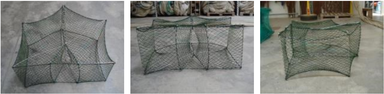
Figura 17. Modello ricreativo: 40 cm in altezza e 100 cm in larghezza, struttura portante realizzata con barre d'acciaio (diametro 5 mm), rete esterna in nylon di colore verde scuro.
