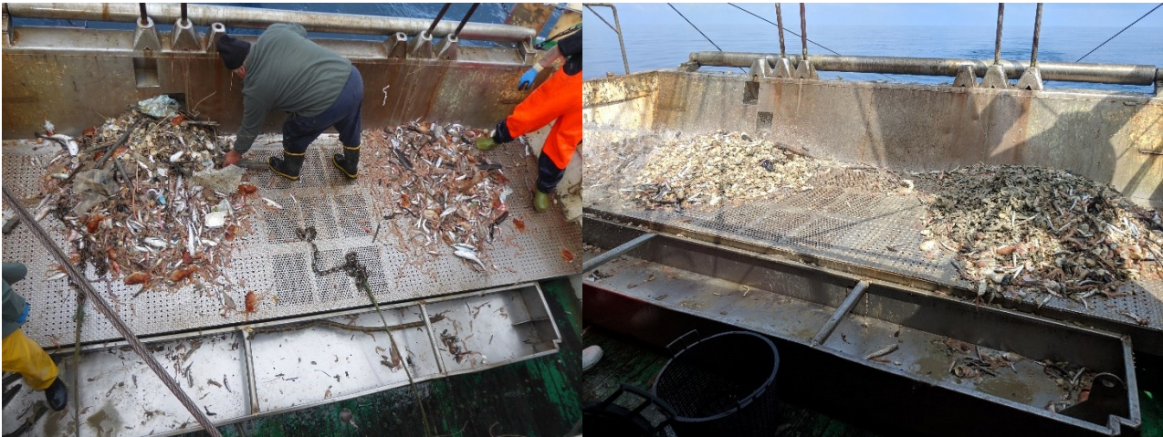
Figura 40. Saccata delle reti gemelle: sacco di destra, rete tradizionale e sacco di sinistra, rete con TED. Si nota come il Marine Litter (sacchetti di plastica e materiale antropico vario) sia quasi totalmente assente in presenza del TED, mentre per quanto riguarda il pescato non ci sono differenze significative.
