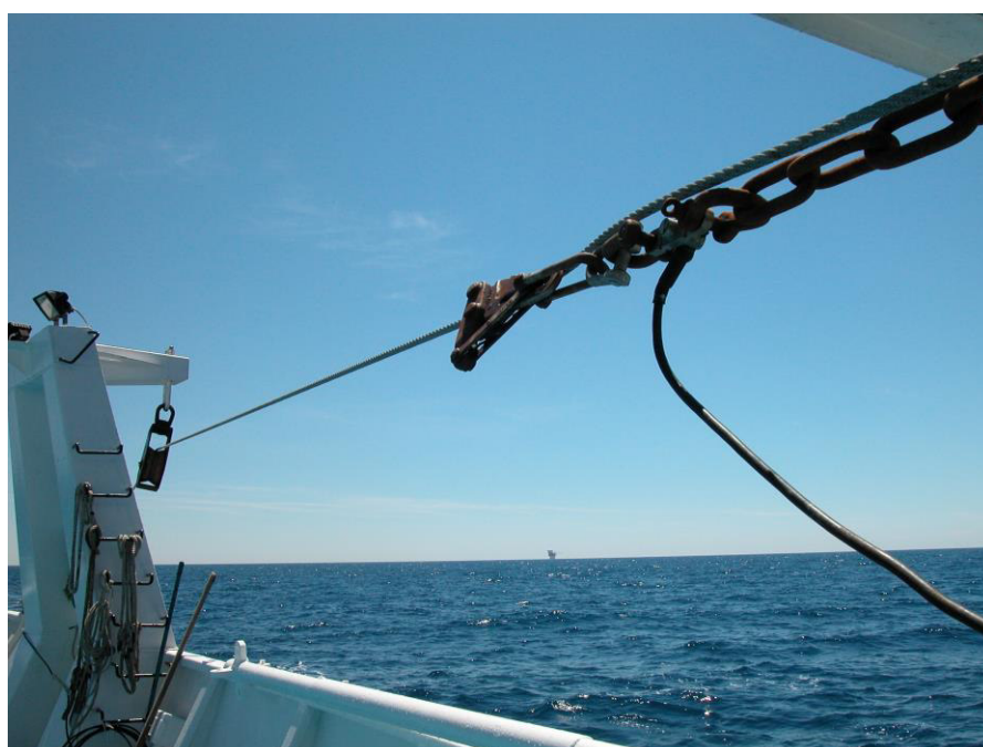
Figura 12. Cella di carico elettronica Tekkal utilizzata per monitorare le forze di traino a bordo.
