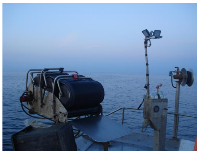
Figura 7. Dettaglio del verricello salparete (a sinistra) e salpa palangari (a destra) dello Skorpio.
