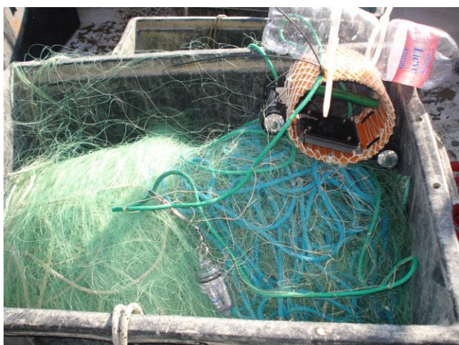
Figura 20. Sistema video con video camera GoPro modello 'Hero 3+ Black' per lo studio della performance del LED-UV in fase di cala e di pesca.
