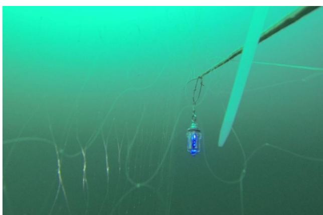
Figura 23. Immagine subacquea del LED-UV in fase di cala: armamento corretto e mantenimento della posizione verticale senza nessun avvolgimento sulla lima da sugheri.
