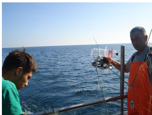
Figura 20. Sistema video con video camera GoPro modello 'Hero 3+ Black' per lo studio della performance del LED-UV in fase di cala e di pesca.
