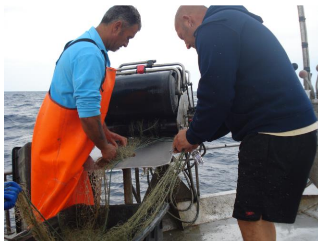
Figura 17. LED-UV in salpa: la lampadina attraversa il verricello e viene facilmente disarmata dal pescatore dalla lima.
