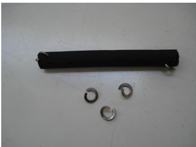
Figura 13. Anelli di acciaio per la chiusura della nassa.
