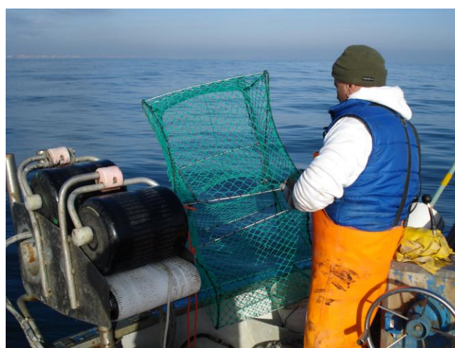
Figura 27. Le nasse Trapula risultano di facile stoccaggio a bordo di piccole imbarcazioni tramite l'uso dei vasconi per le reti (a sinistra) e richiedono l'impiego di un solo marinaio durante le operazioni di cala e salpa (a destra).
