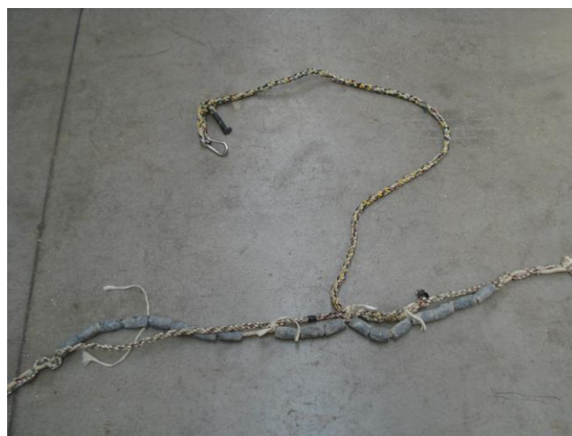
Figura 9. Piombi armati direttamente sul cavo principale e cima con moschettone finale per l'attacco della nassa.
