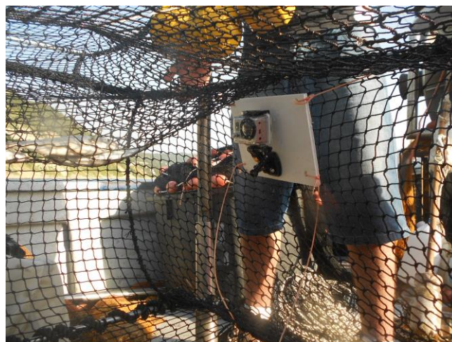
Figura 25. Videocamera 'Mod. Hero 3+ Black' utilizzata per il monitoraggio del comportamento del pesce durante le pesche in mare.
