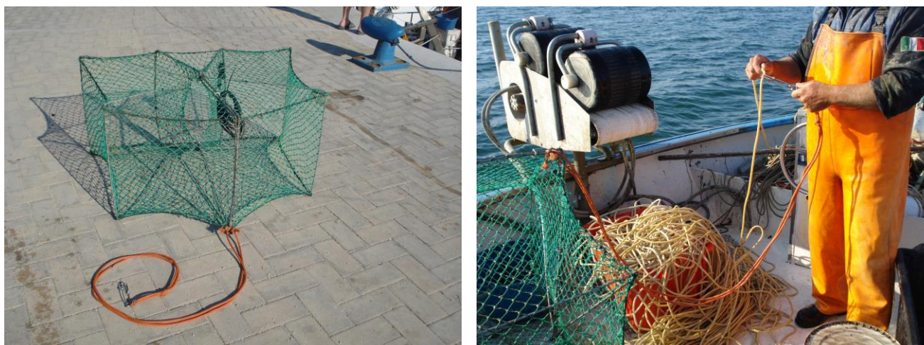
Figura 18. Cima in plastica armata nella parte posteriore della nassa con moschettone terminale (foto di sinistra) per l'aggancio della nassa al calo principale (foto di destra).
