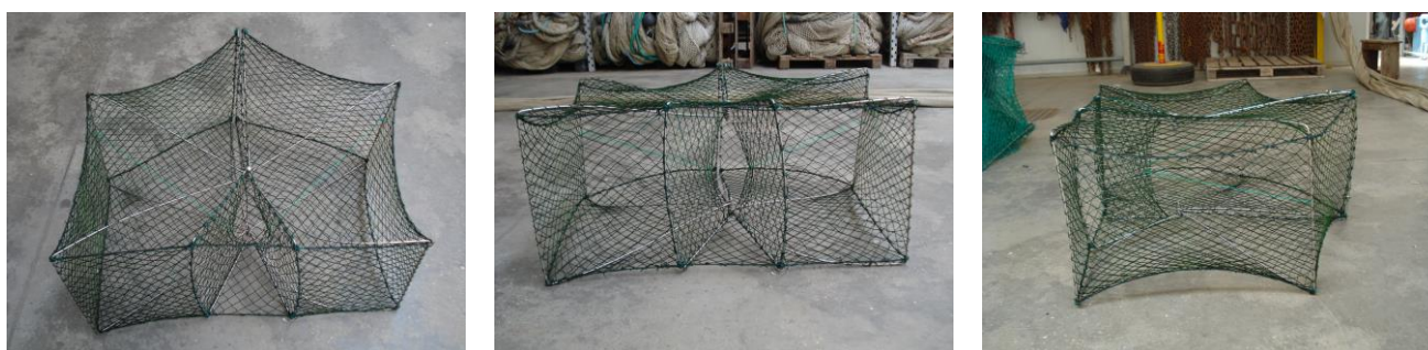
Figura 15. Modello ricreativo: 40 cm in altezza e 100 cm in larghezza, struttura portante realizzata con barre d'acciaio (diametro 5 mm), rete esterna in nylon di colore verde scuro.
