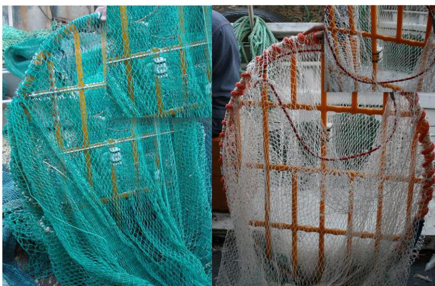
Figura 20. Sensore STAR-ODDI per il rilevamento dell'angolo di inclinazione della griglia montato sulla FLEXGRID utilizzata per le prove in mare con i motopesca Audace (a sinistra) e Rimas (a destra).
