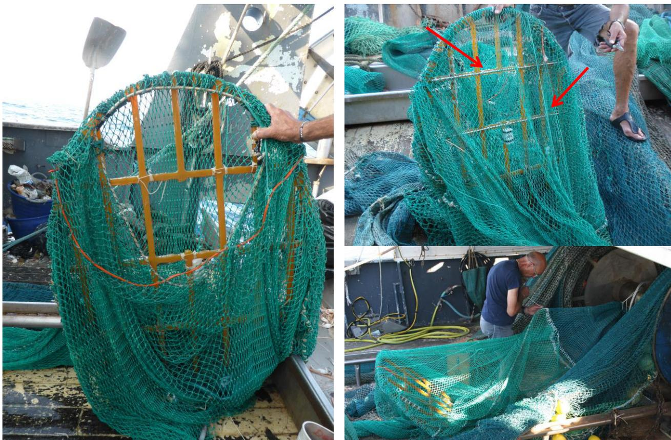
Figura 18. FLEXGRID utilizzata a bordo dell'Audace: a sinistra, dettaglio della griglia con foro centrale (*post-cutting*) e apertura verso l'alto; a destra (in alto), rinforzo della struttura della griglia con tondini di ferro, (in basso) armamento della *grid section* nella rete a strascico.
