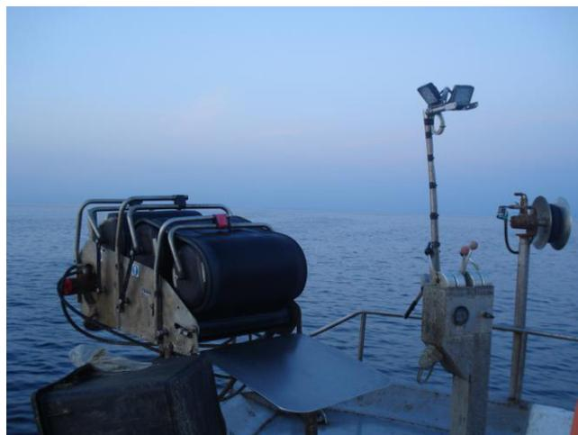
Figura 24. Dettaglio del verricello salparete (a sinistra) e salpa palangari (a destra) dello Skorpio.
