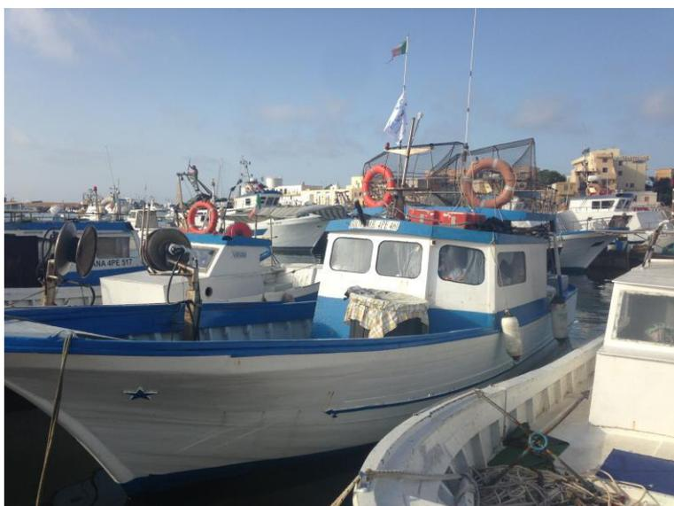
Figura 9. Una delle imbarcazioni impiegate per le battute di pesca sperimentali con palangari derivanti ad ami circolari e tradizionali. L'imbarcazione misura 10.40 metri con motore entroborso da 180 cv.
