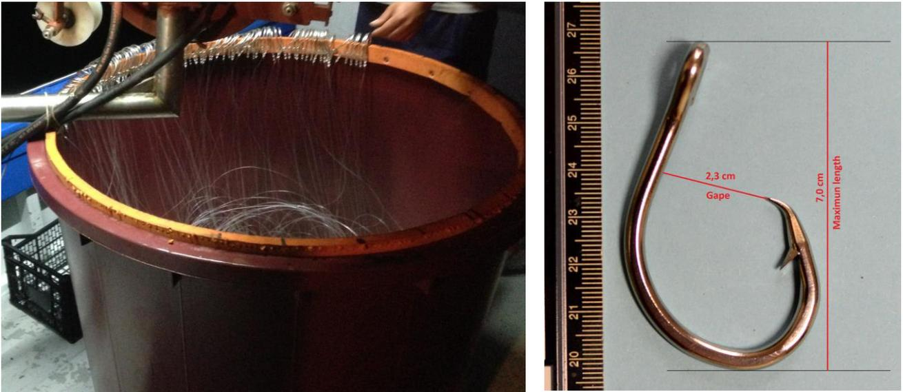
Figura 10. Cesta contenete il palangaro derivante ad ami circolare (immagine di sinistra); Forma e dimensione degli ami circolari adoperati nel presente studio (immagine di destra).
