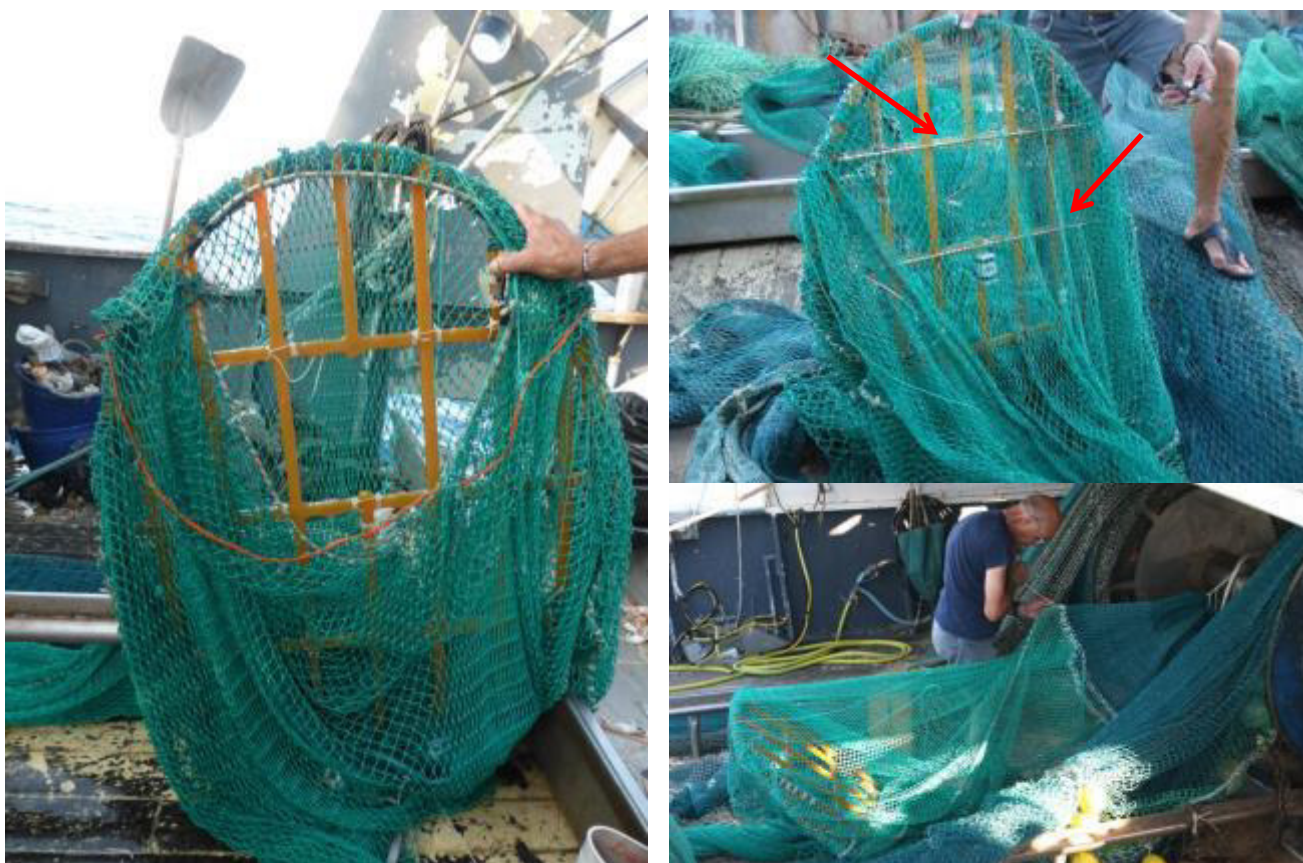
Figura 26. FLEXGRID utilizzata a bordo dell’Audace: a sinistra, dettaglio della griglia con foro centrale ( post-cutting ) e apertura verso l’alto; a destra (in alto), rinforzo della struttura della griglia con tondini di ferro (freccie rosse), (in basso) armamento della grid section nella rete a strascico.
