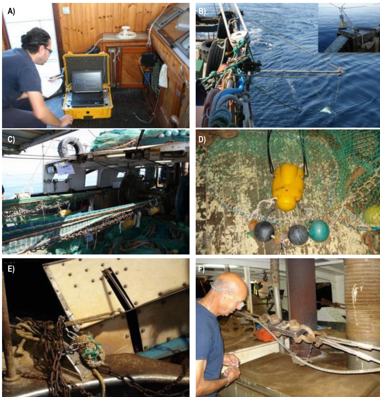
Figura 30. Strumentazione SIMRAD per il controllo dei parametri della rete utilizzata a bordo dell'Audace (Civitanova M.): (a) unità centrale con computer per la visualizzazione e registrazione in real time dei parametri della rete montati durante le prove in mare; (b) struttura in acciaio composta da un braccio (boom), armatura dell'idrofono (paravan) e cavo di trasmissione idrofono - computer di bordo; (c) sensori per la misurazione dell'apertura orizzontale della singola rete e dell'apertura totale di entrambe le reti armati sulla lima dei sugheri; (d) sensore per la misurazione dell'apertura verticale montato sul "carione"; e) sensore per la misurazione dell'apertura dei divergenti montato sulla braga; e) dinamometro Dinafor per la rilevazione dei carichi di traino.
