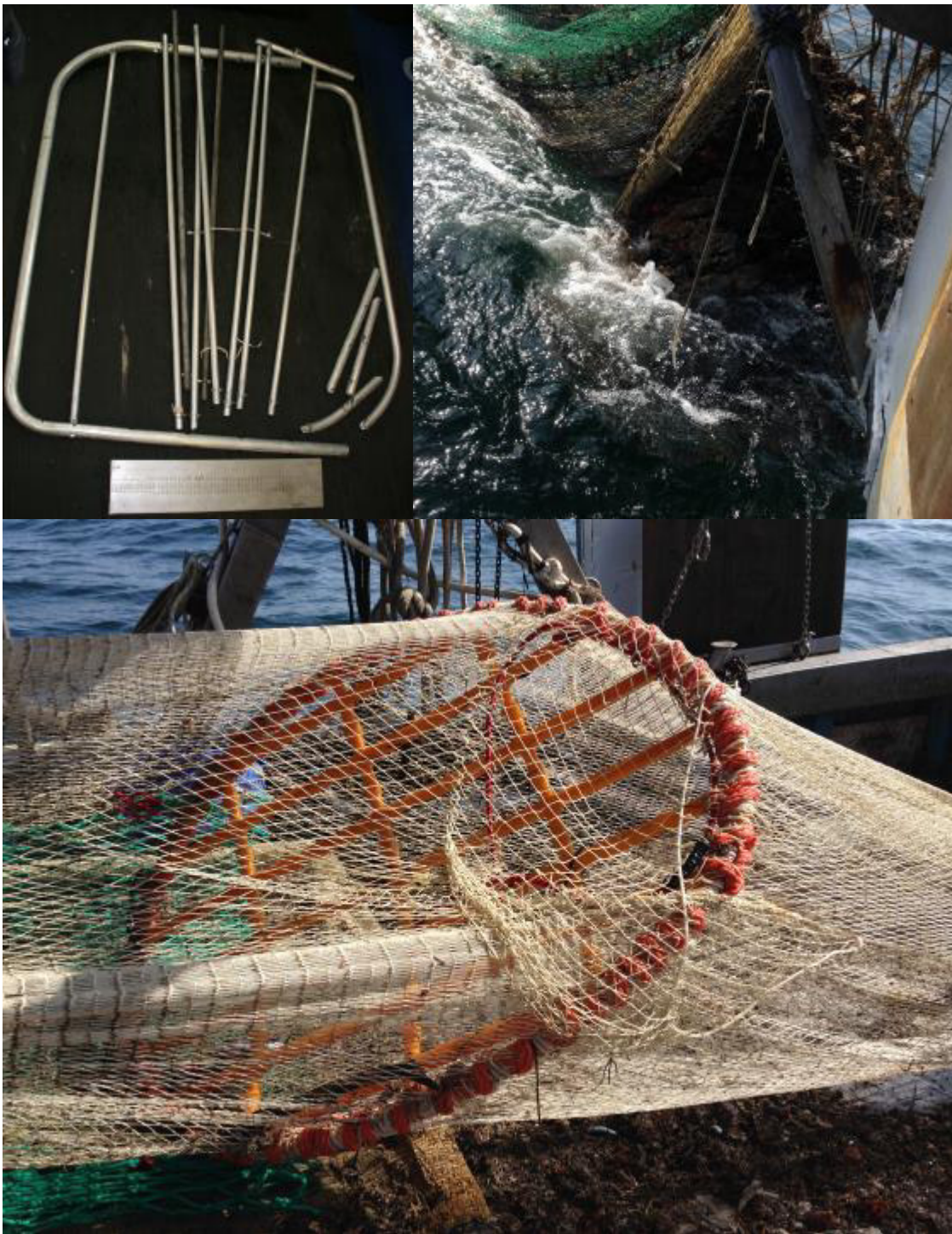
Figura 75. Problematiche a bordo: rottura del TED. In alto: a sinistra rottura di uno dei TED testati in TARTANET, a destra, scoglio preso durante una cala con FLEXGRID; in basso, FLEXGRID intatto durante la salpa nonostante l'impatto e il peso dello scoglio.
