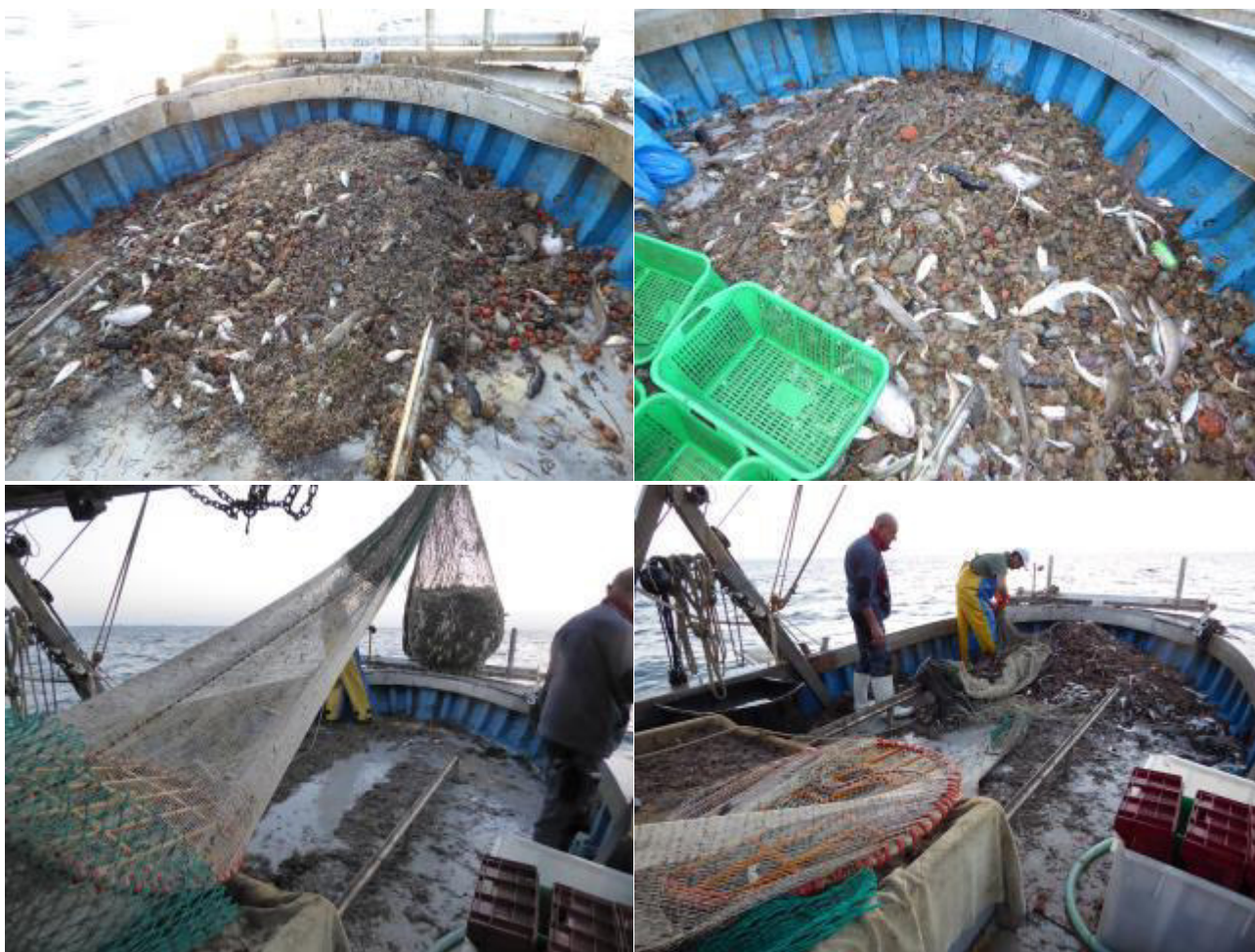
Figura 72. In alto: cattura con FLEXGRID (a sinistra) e con rete tradizionale (TRADIT) a destra. In basso, flessibilità del TED sottoposto ad elevati carichi e sollecitazioni in fase di salpa.
