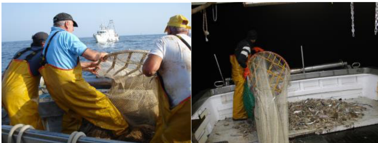
Figura 76. Problematiche a bordo: salpa del TED. A sinistra, il Supershooter viene salpato faticosamente da 3 pescatori (Cesenatico, progetto Bycatch); a destra, il modello FLEXGRID viene salpato con semplicità da un solo pescatore (Cesenatico, progetto TartaLife).
