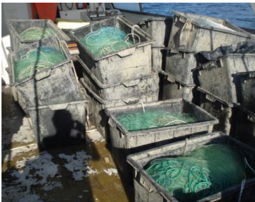
Figura 34. Reti da imbrocco utilizzate durante la fase di messa a punto dei dissuasori visivi. Le reti vengono riposte in contenitori di plastica da 180 L totali con dimensioni 73x51x48 cm.
