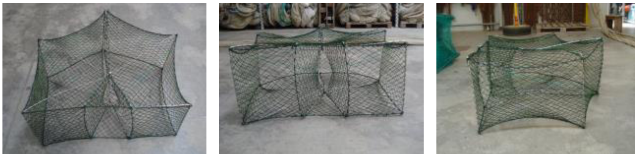
Figura 43. Modello ricreativo: 40 cm in altezza e 100 cm in larghezza, struttura portante realizzata con barre d'acciaio (diametro 5 mm), rete esterna in nylon di colore verde scuro.
