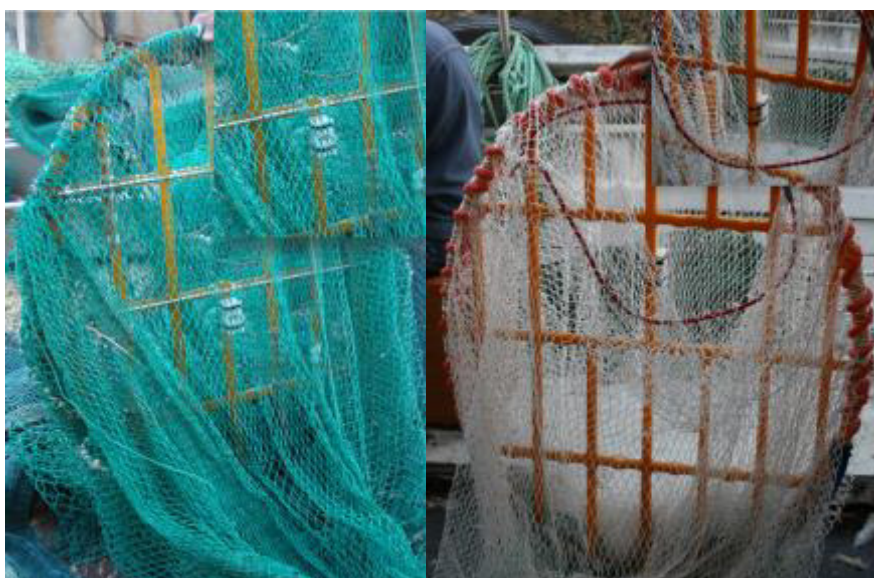
Figura 29. Sensore STAR-ODDI per il rilevamento dell'angolo di inclinazione della griglia montato sulla FLEXGRID utilizzata per le prove in mare con i motopesca Audace (a sinistra) e Rimas (a destra).
