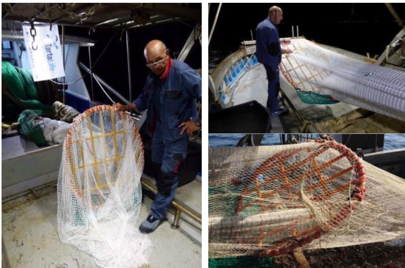
Figura 27. FLEXGRID impiegata per le prove in mare con il motopesca Astuzia (Marano Lagunare): a sinistra, dettaglio della griglia con apertura verso l'alto; a destra, griglia in fase di cala (in alto) e di salpa (in basso).
