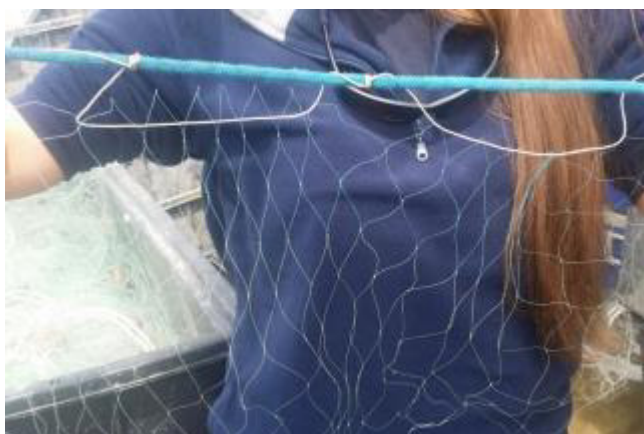
Figura 37. Dettaglio della lima da sugheri: la lima non presenta galleggianti esterni e ha un diametro di 5.5 mm.
