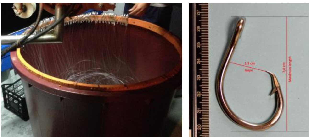
Figura 11. Cesta contenete il palangaro derivante ad ami circolare (immagine di sinistra); Forma e dimensione degli ami circolari adoperati nel presente studio (immagine di destra).
