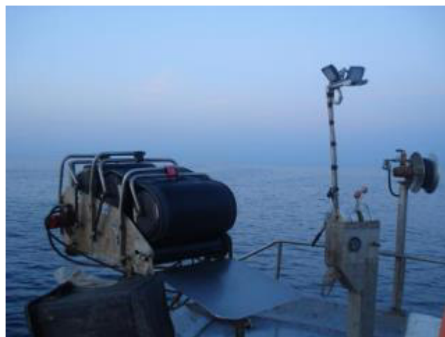
Figura 33. Dettaglio del verricello salparete (a sinistra) e salpa palangari (a destra) dello Skorpio.
