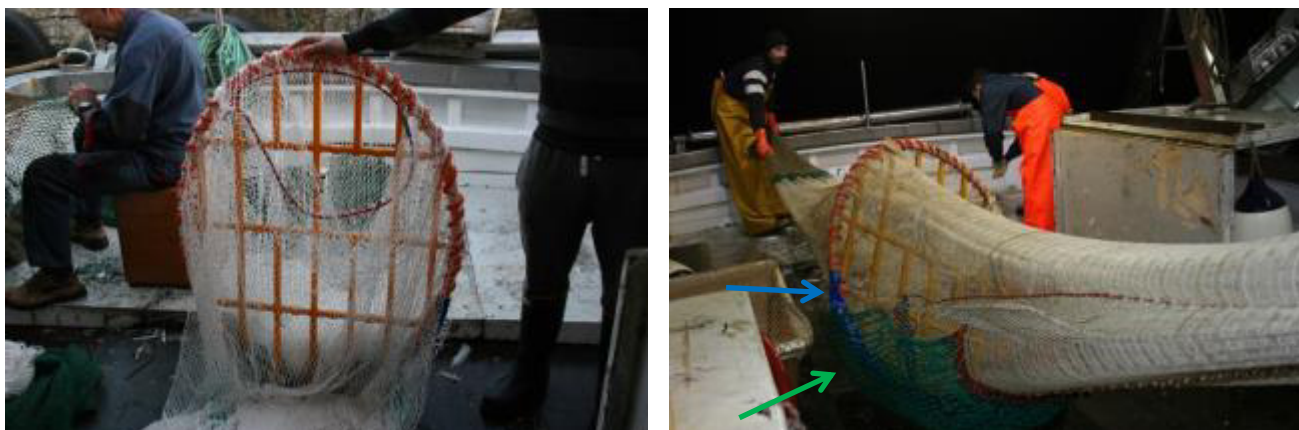
Figura 28. FLEXGRID impiegata per le prove in mare con i motopesca romagnoli (Rimas e Joacchi): a sinistra, dettaglio della griglia con doppio foro laterale e apertura verso l'alto; a destra, dettaglio della rete di protezione del lato inferiore della griglia (in verde) e del rivestimento di protezione in plastica applicato direttamente sulla griglia (in blu).
